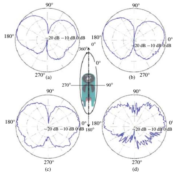
Fig. 5. Antenna vertical radiation pattern. (a) 3 GHz. (b) 4 GHz. (c) 5 GHz. (d) 6 GHz.
