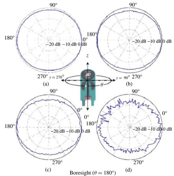
Fig. 4. Antenna horizontal radiation pattern. (a) 3 GHz. (b) 4 GHz. (c) 5 GHz. (d) 6 GHz.
